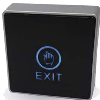
Botón de salida TOUCH COD. SGBT10 Alimentación: DC12V Contacto seco: 12-36V, 3A Salida: NO/COM/NC
